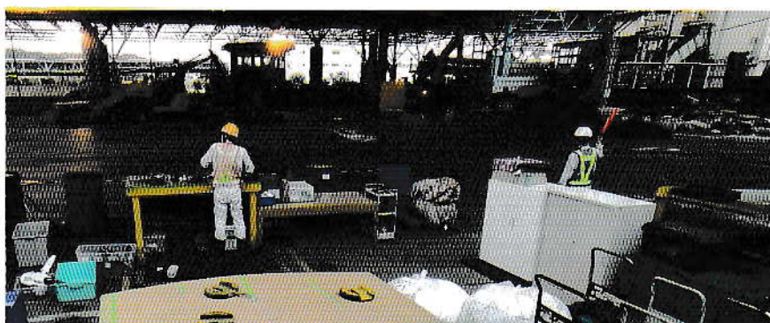
火災を防ぐため、充電式電池などを手作業で取り除きます
